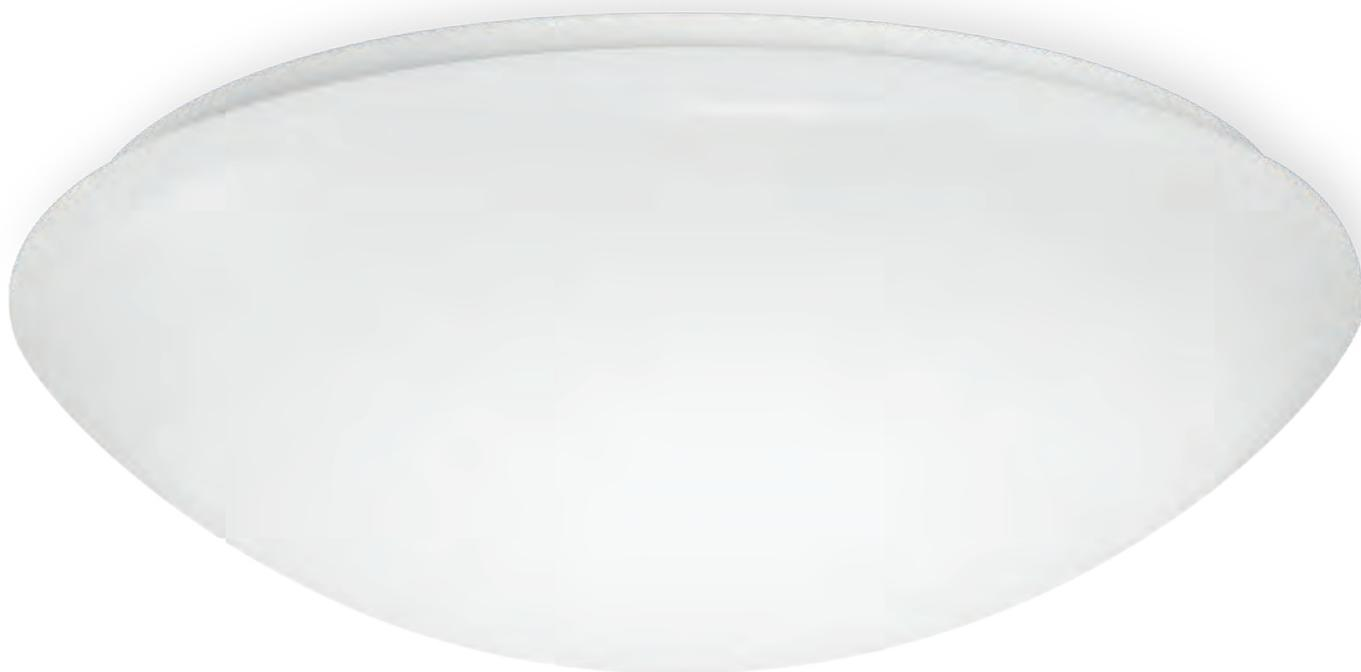
Starlight S02 ist eine Allgemeinleuchte mit integrierter Notlichtfunktionalität. Optisch von unserer reinen Allgemeinleuchte nicht zu unterscheiden, versorgt das integrierte Notlichtmodul das LED-Panel im Notbetrieb mit reduzierter Leistung. Geeignet zur Ausleuchtung von Flächen und Rettungswegen gemäß DIN 1838.
