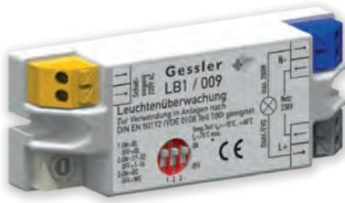
Unter Einsatz des Gessler LB1/009-Bausteins können Rettungs- und Sicherheitsleuchten in einem Stromkreis (Mischtechnik) realisiert werden. Das bedeutet eine erhebliche Einsparung bei der Installation bzw. Reduzierung der Brandlast. Der Baustein ist sowohl für AC- als auch für DC-Netze geeignet.
