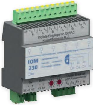
IOM230 ist ein Schalterabfragemodul mit integriertem BUS-Phasenwächter. Wahlweise kann das Modul im Notlicht-Systemschrank oder in der Verteilung der Allgemeinbeleuchtung untergebracht werden. Mittels Drehcodierer wird jedem Modul eine eindeutige BUS-Adresse zugewiesen. Die Zuweisung eines Standorttextes (um eine lokale Störung des AV-Netzes zielgenau beheben zu können) ist jederzeit möglich.
