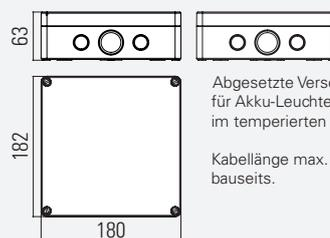
Abgesetzte Versorgungseinheit für Akku-Leuchte zur Montage im temperierten Innenbereich.
