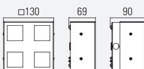
Ballwurfsichere Ausführung in IP43. Für den Einsatz in Sportstätten geeignet. Seitliche Kabeleinführungen können durch Höhenverstellung freigelegt werden.
