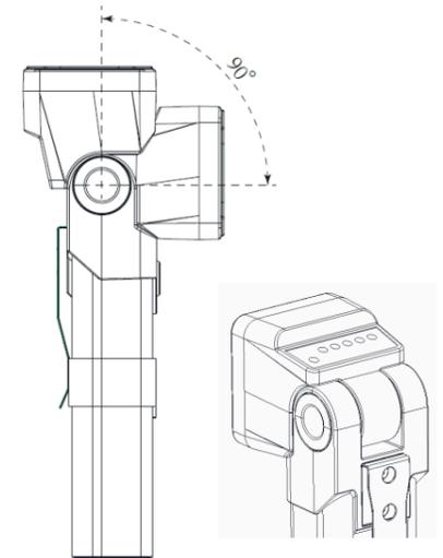
Um den Lichtstrahl in einen gewünschten Winkel einzustellen, kann der Lampenkopf in kontinuierlichen Winkeln von vertikal 0° bis 30° vorne und 90° nach hinten geschwenkt werden.
